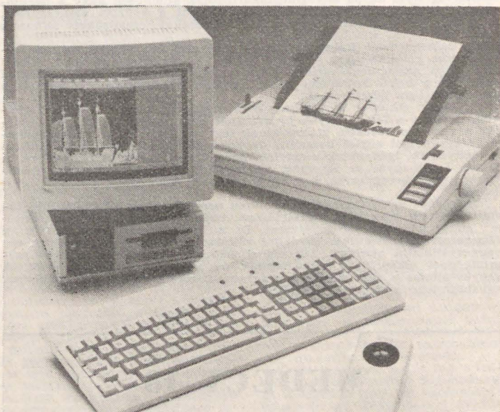
Apricot F10 a Writer 22 mátrixnyomtatóval és egérrel
