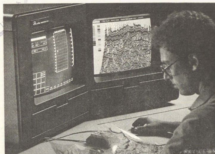
A Scitex cég Response-800 szeizmikus értelmező rendszerének Imager-II munkahelye 48 cm-es, színes ikermegjelenítővel
