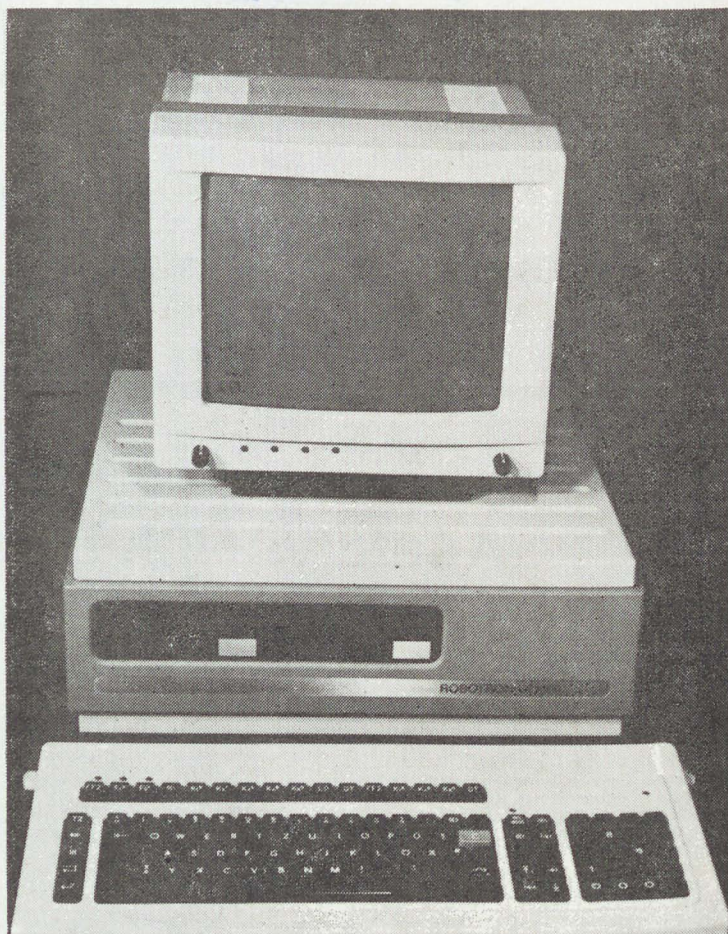
A 7100 — a szocialista országokban gyártott 15. mikroszámítógép típus, mely kompatibilis az IBM PC-vel
