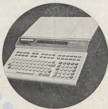
HP 9831 — Belső tár: 8–32 KByte. A beépített, két irányban kereső, nagy sebességű mágnesszalag egység egy kazettán 250 KByte-ot tárol. Speciális függvény billentyűkkel, egy vagy két gomb lenyomásával 24 előre rögzített program válik hozzáférhetővé. Könnyen elsajátítható programnyelv.
