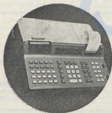
HP 9815 — Tárhelykapacitás: 2008 programlépés. A mágnesszalag egység 96 KByte-ot rögzít. RPN logika és egyszerű gépi nyelv. Számos, előre beprogramozott matematikai és statisztikai függvény. Programszerkesztést elősegítő gombok, jól olvasható kijelző, alfanumerikus nyomtató.
