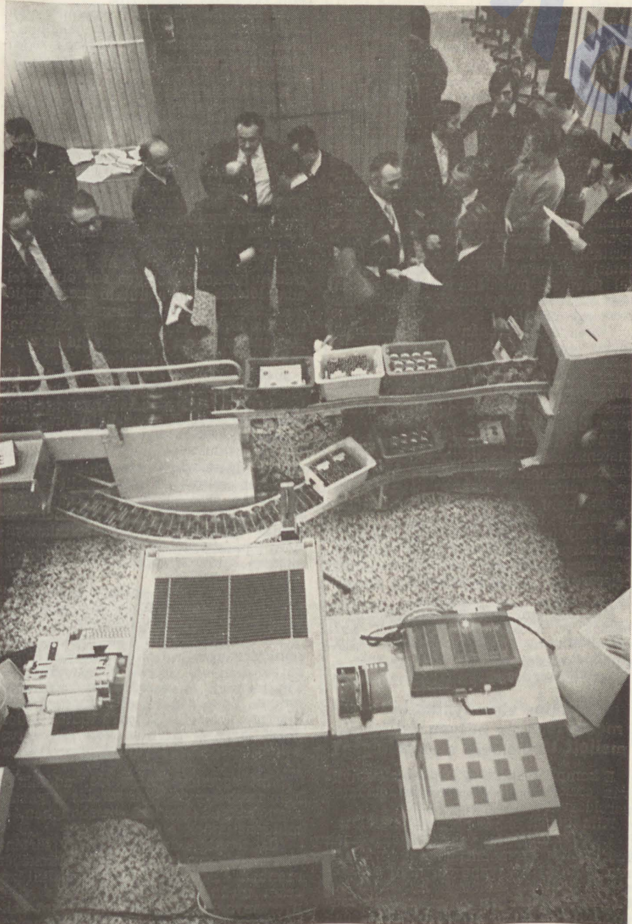
A videojel vezérlésű darabáru szállító és irányító rendszer működés közben a bemutatón.
