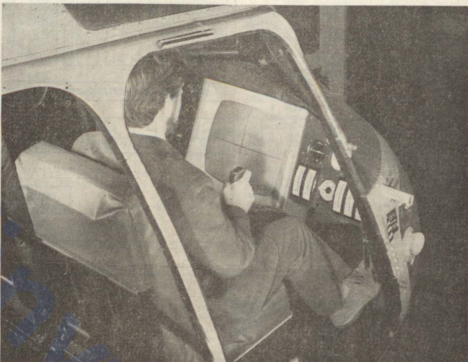
Nyugalmi állapotban levő helikopter vizsgálata Pacer 600 hibrid számítógéppel az angliai National Gas Turbine Establishment vállalatnál. A vizsgálat célja a hajtómű és a forgórészek kölcsönhatásának elemzése. Az új hibridszámítógép fontos előrehaladást jelent a repülőgépmotorok és irányítási rendszereik tervezésére használt módszerek fejlődésében.
