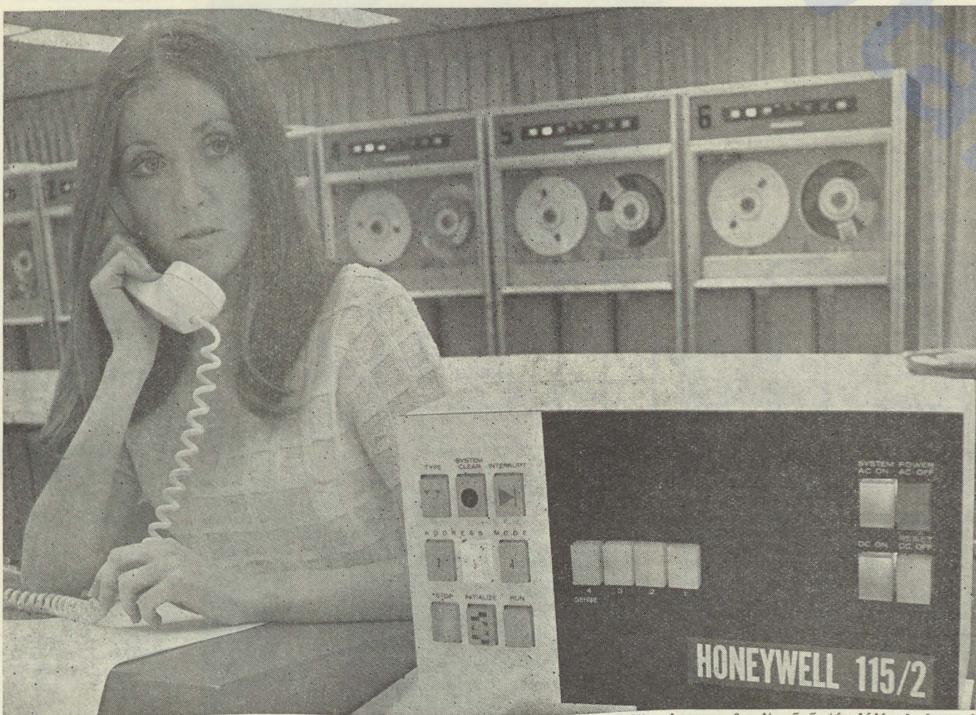
A Honeywell-Bull cég új, 115/2 jelű kis-számítógépe. A gép ciklusideje 2,25 microsec, ferritgyűrűs tárolójának kapacitása 65 536 karakterig bővíthető. Perifériális berendezéseit integrált vezérlőrendszer irányítja.
